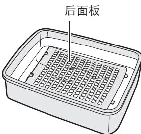
1. 在水中滴几滴厨房用洗涤剂，将后面板浸泡 10 分钟左右。
