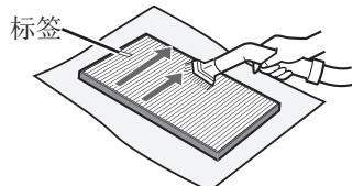
只可清洁表面贴有标签的部位。请勿清洁反面。过滤网容易破裂，务必小心，不可施加过大力量。
