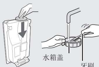
用软海绵清洗水箱内壁，用棉签或牙刷清洗水箱盖。
